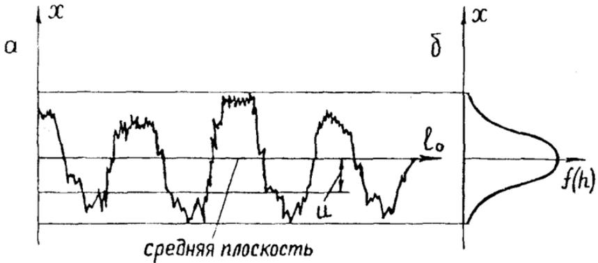
Рис. 2.1. Профиль обрабатываемой поверхности (а) и плотность распределения ординат неровностей (б)
